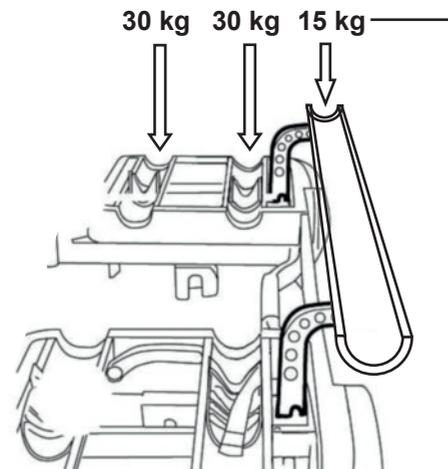
**Maximale Belastung pro Radschiene**
